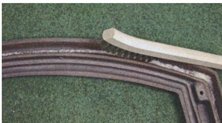
古いガスケットを取り除き、ワイヤーブラシやマイナスドライバーで溝を掃除します。
