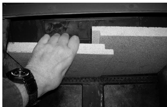
B) 右側のバッフルを少し持ち上げながら右へ逃がし、左側のバッフルを手前へ引いて外します
