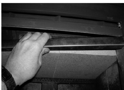
A) バッフルガードを外します
