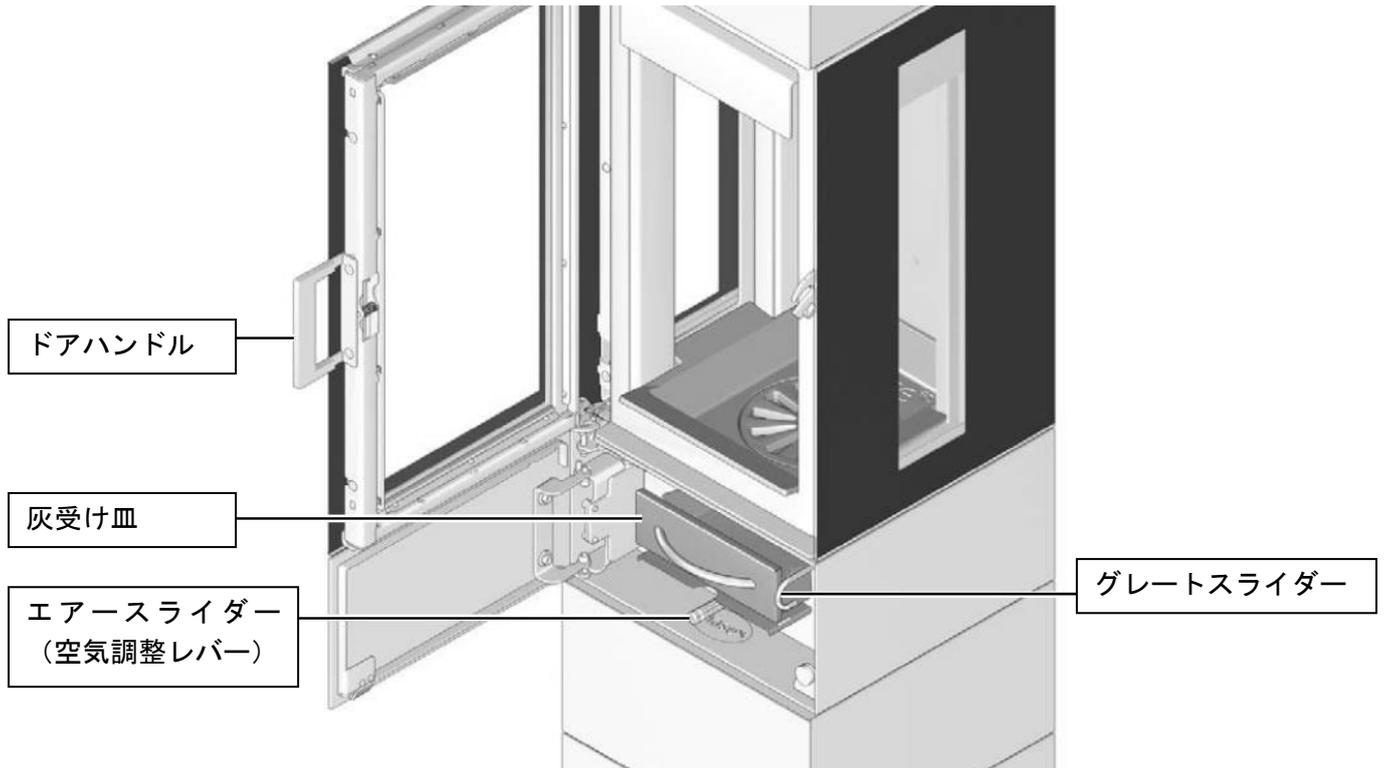
\* ドアを閉じた状態での燃焼を前提としたストーブのため、ドアを開けたまま手を放すとドアは自動で閉まります。
