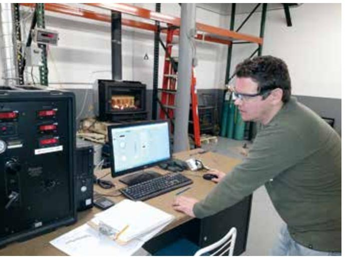
2020 年 5 月から改定される排気煙量規制値をクリアーするため、ハーストーンでは、二次燃焼クリーンバーンシステムに触媒による三次燃焼を加えました。
